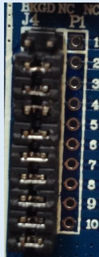
图 7 ZigBee 1 脚断开短路帽测量电流示意图
